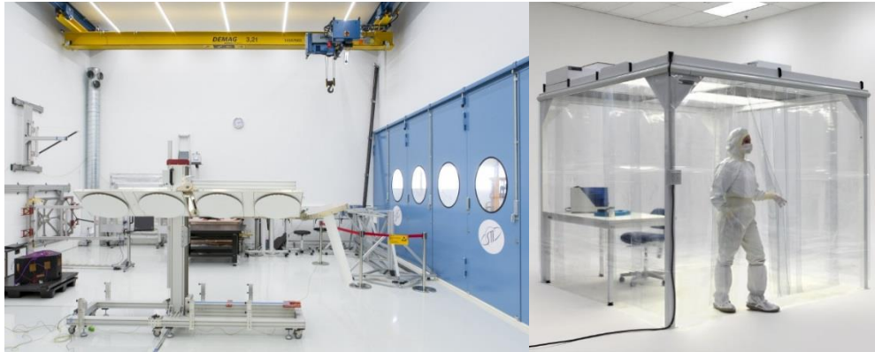
Figura 9. Exemplu de cameră curată destinată utilizării în industria spațială
